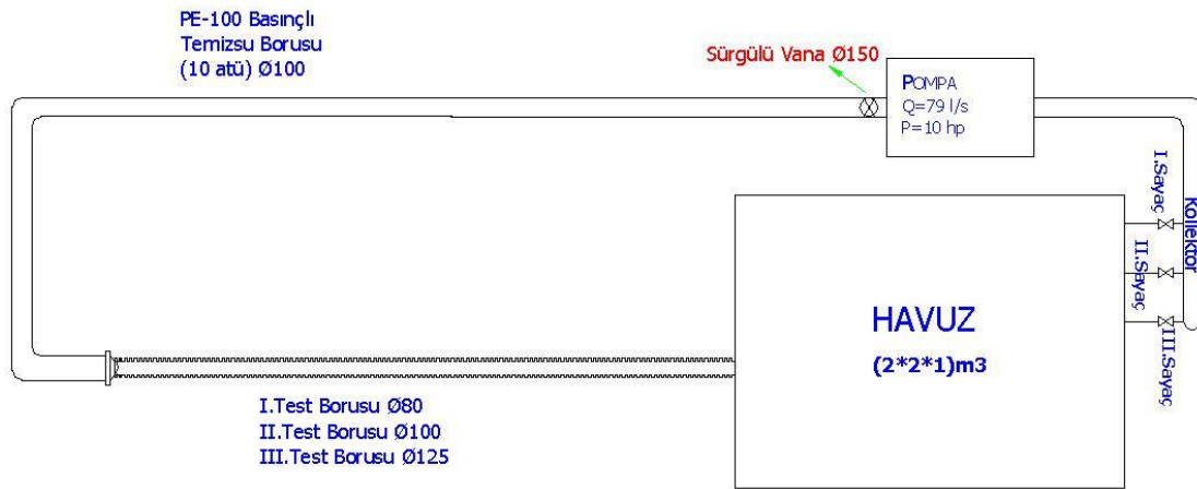
Şekil 1. Deney tesisatının üst görünüşü
