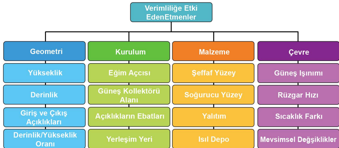
Şekil 4. Güneş bacasının verimliliğine etki eden etmenler
