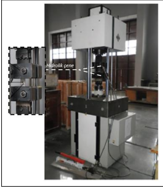
Şekil 14. Yüksek döngü yorulma test düzeneği [22].
