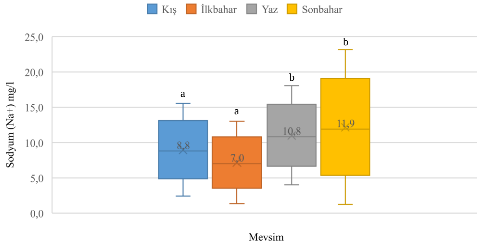
Şekil 5. Çöppınarı deresinde sodyum miktarlarının mevsimlere göre değişimi
