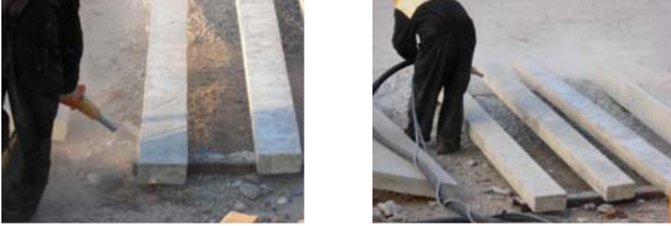
Şekil 2. Kiriş numunelerine kum püskürtülerek yüzeyinin hazırlanması
