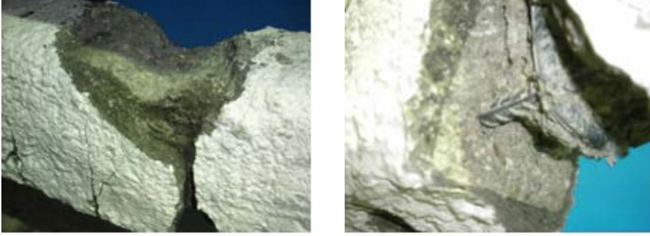
Şekil 4. Kuru karışım püskürtme betonla güçlendirilmiş kirişin eğilme deneyi sonrası durumu
