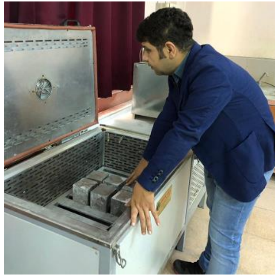
Şekil 8. Donma/çözülme test işlemi
