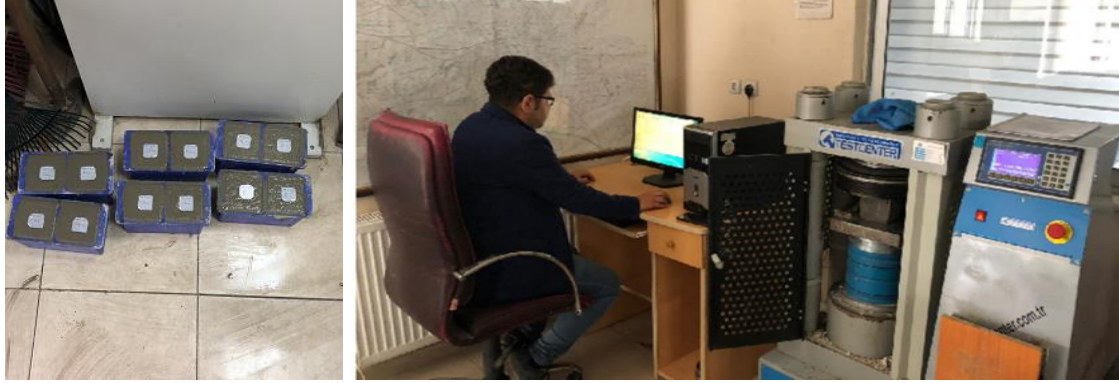
Şekil 5. Bir grup küp numune ve test edilme işlemi
