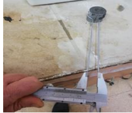
Şekil 3. a) Priz süresi tayini işlemi, b) Hacimsel genleşme işlemi
