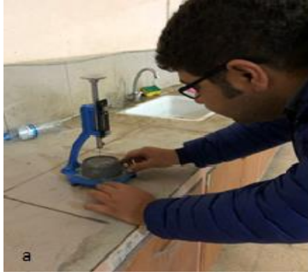
Şekil 3. a) Priz süresi tayini işlemi, b) Hacimsel genleşme işlemi
