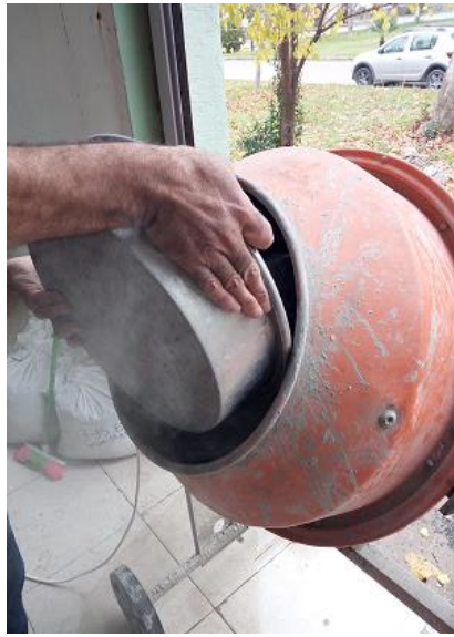
Şekil 4. Betonun karıştırılması ve çökme değerinin bulunması
