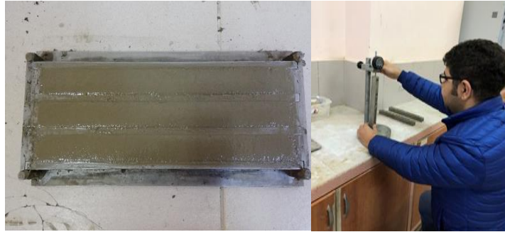
Şekil 6. Prizma numuneler ve test işlemi
