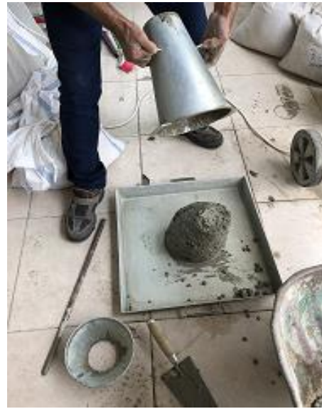
Şekil 4. Betonun karıştırılması ve çökme değerinin bulunması
