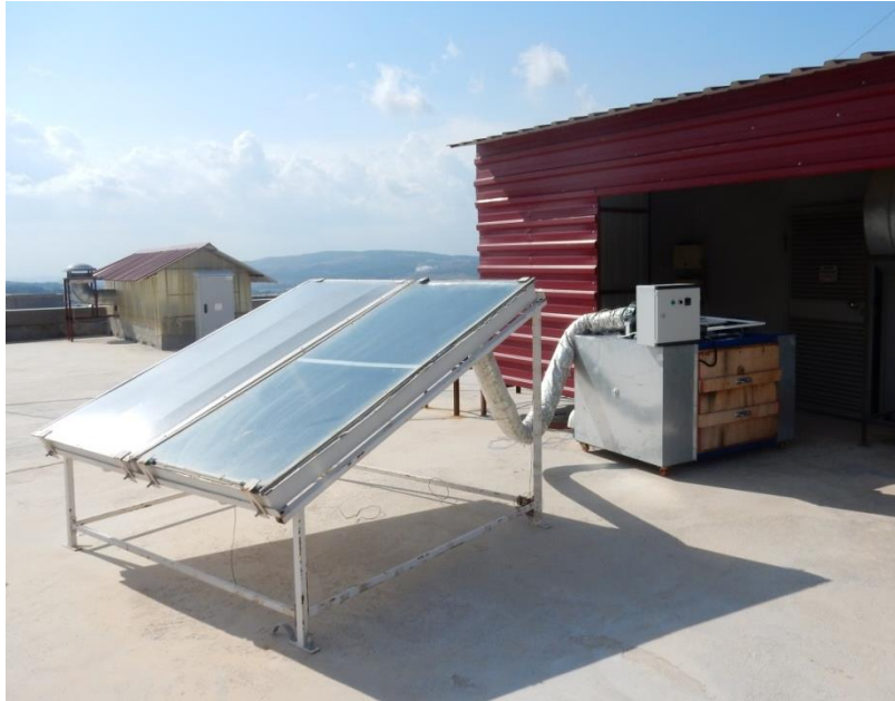
Şekil 2. Güneş enerjisi destekli kurutma sisteminin resmi
