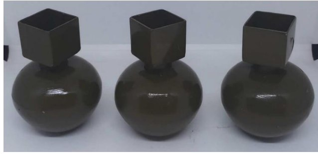
Şekil 9. Üretilen fünyenin M67 el bombasına entegre edilmiş hali
