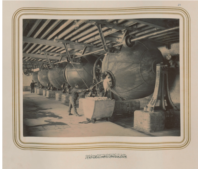
Fotoğraf 4: Kâğıt Hamurunu 100 Derecelik Sıcaklıkla Temizleyen Dönen Kazanlar
