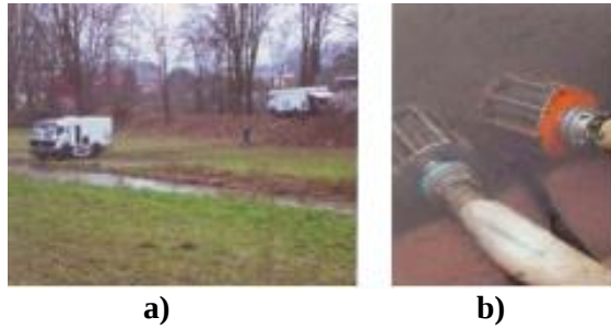
Şekil 13. a) Filtreli enjektörler, su birikintilerinden (gölet, dere) araçlara su çekebilirler, Şekil 13. b) Enjektörlerle araç daha hızlı doldurulur
