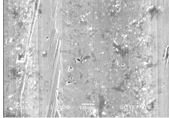
Şekil 10. Kaplamasız karbür matkapla elde edilen delik alın yüzey SEM görüntüsü [10].
