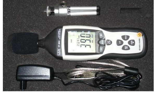
Şekil 4: Ses seviyesi ölçüm cihazı.
