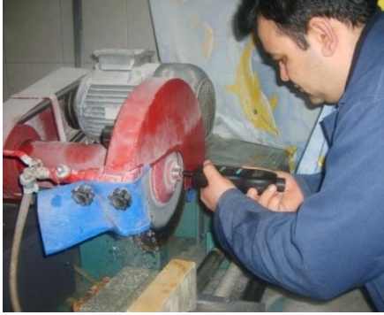
Şekil 3: Mermer kesme işlemi sırasında devir ölçümü.
