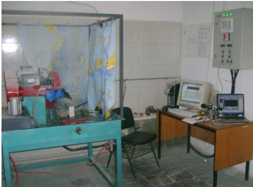
Şekil 1: Kayaç kesme seti ve gürültü seviyesi ölçümü.
