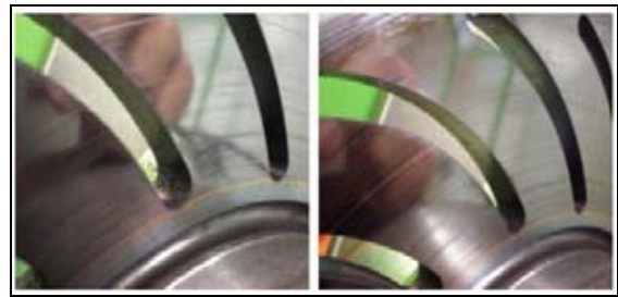
Şekil 4. Boyuna kanallı diskte frenleme sonrası kanallarda birikmiş balata tozları.
