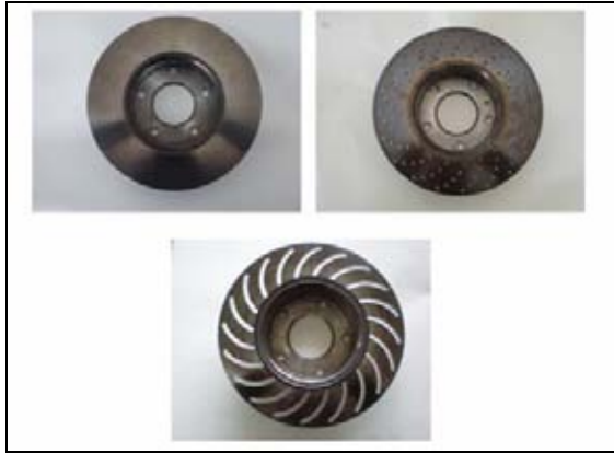
Şekil 1. a) ATE katı disk, b) Enine kanallı disk, c) Boyuna kanallı disk.
