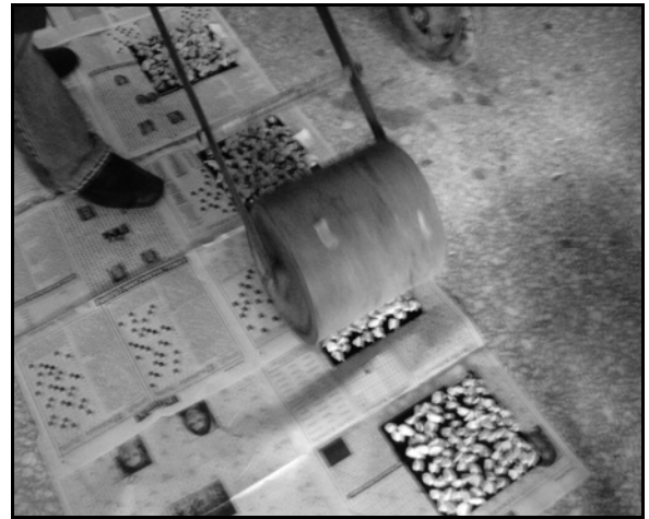
Şekil 7. Mekanik sericiye yerleştirilmiş ve silindirlenme esnasındaki numuneler.
