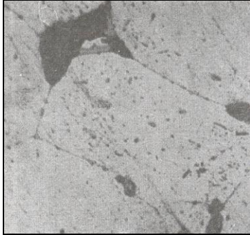
Şekil 6. 510 °C'da homojenizasyon uygulanmış içyapı (*500).
