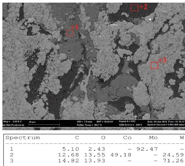
Şekil 3: WCCo-%40 Mo kaplama tabakasının EDS analizi.
