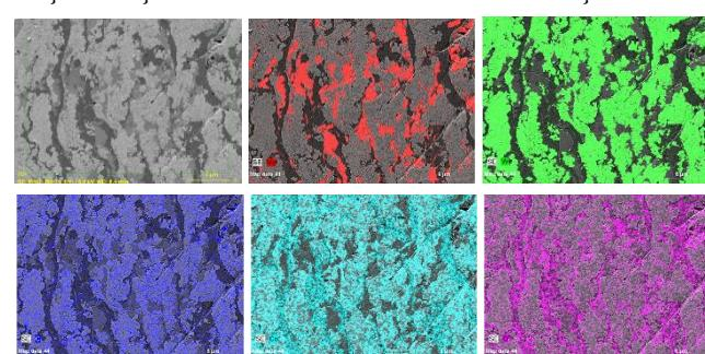
Şekil 2: WCCo-%40 Mo kaplama tabasının MAP analizi.
