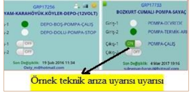
Şekil 7: Pompa kontrol akıllı sistemi önyüzü.
