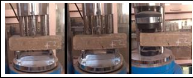
Şekil 3. Harçlar üzerinde yapılan eğilme ve basınç deneyleri.
