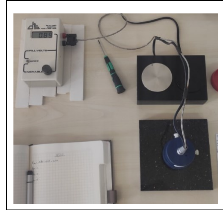
Şekil 6. Isıl Yayılımı Cihazı (termal emissometer) ile deney numunesinin \epsilon değerlerinin ölçülmesi.
