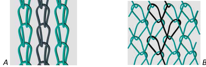
Çizim 2 Franse (zincir örgü) yapısı (A) ve komşu iğnelerle bağlantı oluşumu (B).
