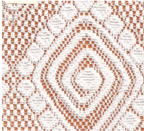
Fotoğraf 5 Jakarlı raşel örme makinesinde, ince ve kalın iki iplikle oluşturulan hacimli desen.
