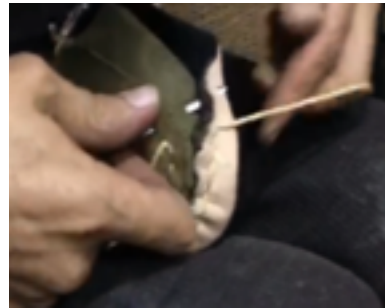
Fotoğraf 16. Kösele ile üstlük kısmının dikilerek birbirine Tuturulması (Kılıç Karatay, 2019)
