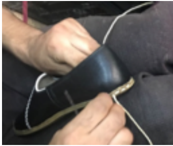
Fotoğraf 19. Yemeninin dıştan dikilmesi (Kılıç Karatay, 2019)
