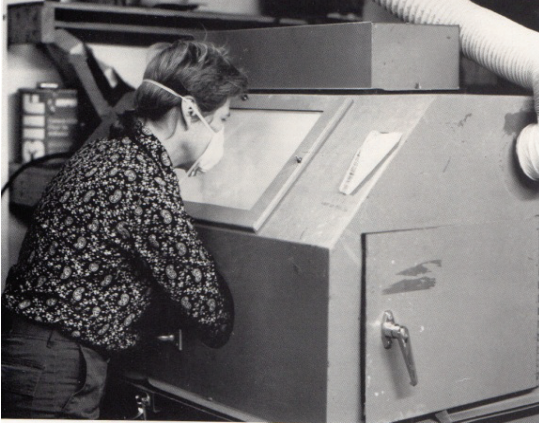
Görsel 2. Kumlama Makinası, Littleton Atölyesinden
