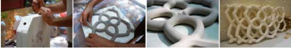
Görsel 14. Evaporatif seramik modül üretim süreci (http 23).
