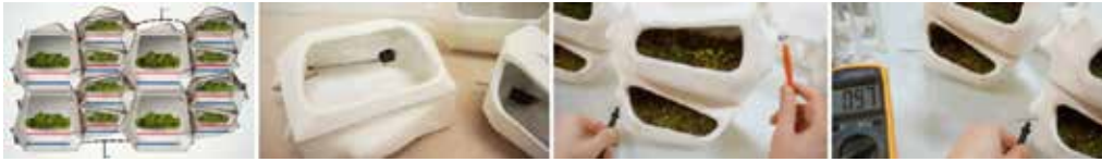
Görsel 13. Seramik modüllere yerleştirilen yosun ve elektrik üretimi (http 20).
