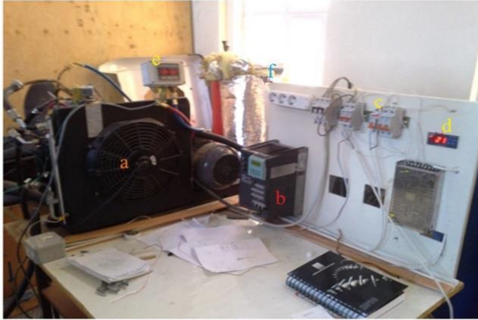
Şekil 4. Deney düzeneğinin önden görünüşü ve kontrol paneli a. Fan, b. İnvörtör, c. Elektrik açma kapama şartelleri, d. Ortam sıcaklığını ölçen termometre, e. Kompresör giriş ve çıkış basınçlarını ölçen manometre, f. Koltuk soğutmayı devreye sokan sivitç
