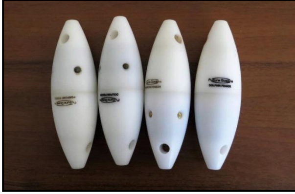
Şekil 2. Denemelerde kullanılan yunus kovucular Figure 2. Acoustic deterrents used in the trials
