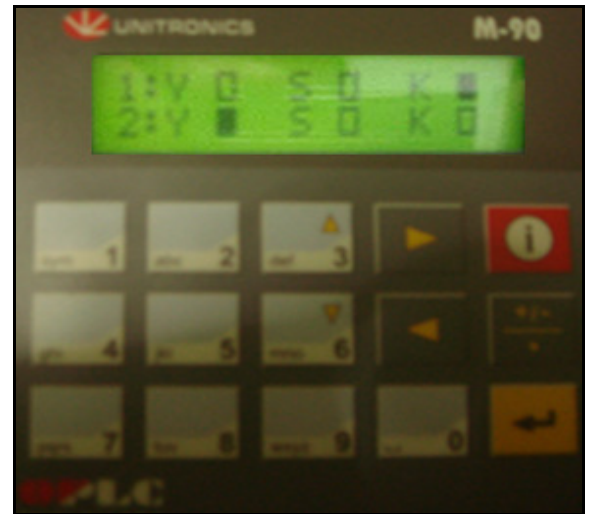
Şekil 9. Sistem çalışır durumdayken PLC üzerinde trafik ışıklarının yanma durumları (1: Birinci yol, 2: İkinci yol, Y: Yeşil, S: Sarı ve K: Kırmızı)
