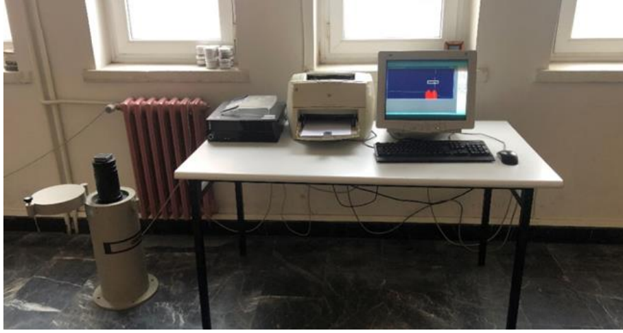
Şekil 1. Radyasyon zırhlaması deney düzeneği
