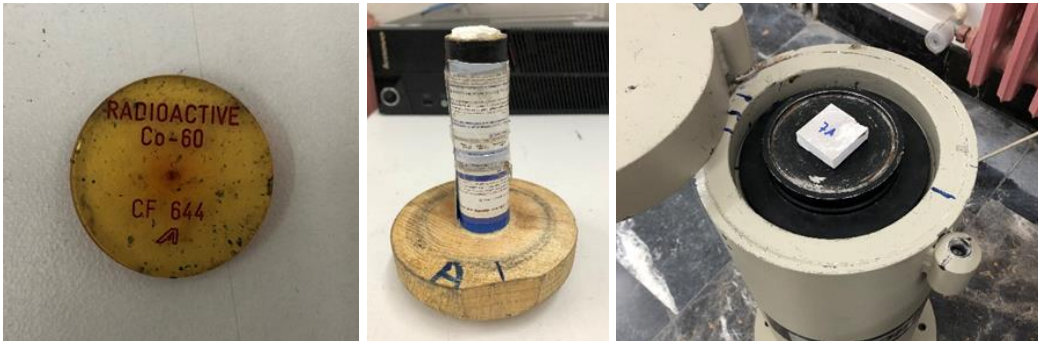
Şekil 3. Deneylerde kullanılan radyoaktif kaynaklar ve polimer beton numunesi
