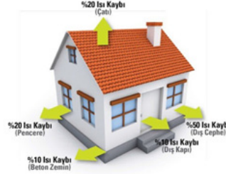
Şekil 1: Binada Isı Kaybı ve Oranları
