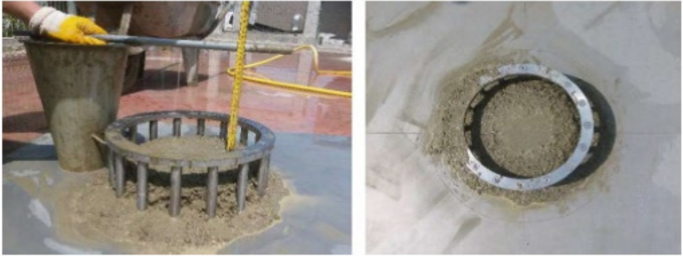
Şekil 7. J halkası Donatıları Arasında Sıkışan Lifler (Ouedraogo, 2018).
