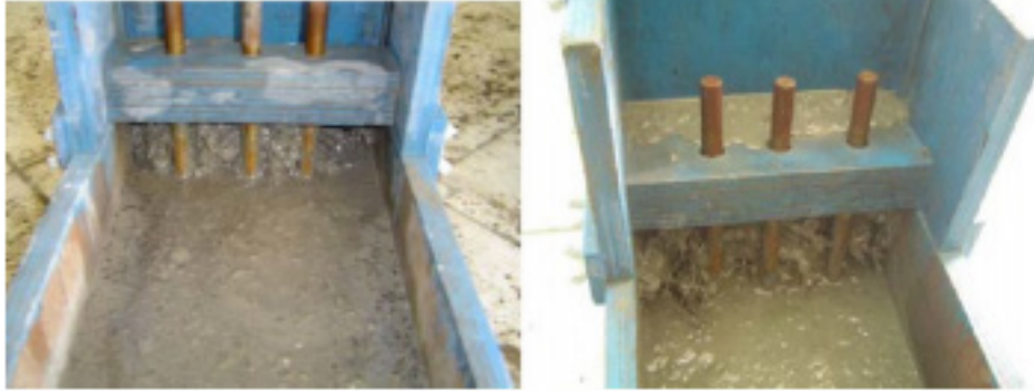
Şekil 4. L Kutusu Deneyi (Deney sırasında çelik lif oranında artışa gidildikçe donatılar arasından liflerin geçemediği gözlemlenmiştir) (Yıldırım, Sertbaş & Berbergil 2007).
