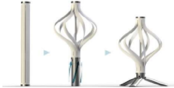
Şekil-2. Katlanabilir Rüzgar Türbini (Jalloul, 2020).
