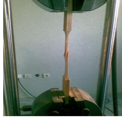
Şekil 11. Liflere paralel çekme direnci deneyi
