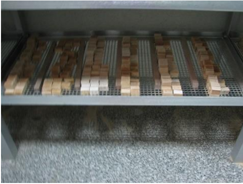
Şekil 2. Yoğunluk tayini için hazırlanan örneklerin iklimlendirme odasında \%12 nem oranına ininceye kadar bekletilmiştir
