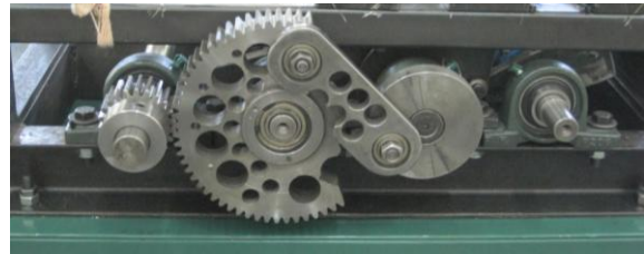
Şekil 11. Tahrik mekanizması sabit montaj durumu (sol taraf)
