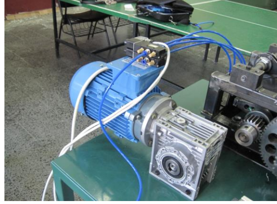
Şekil 9. Motor ve redüktörün montaj durumu
