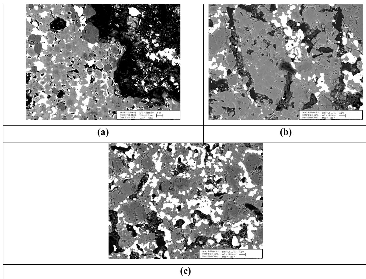
Şekil 6. M-%30S-%30Zirkon kompozisyonuna sahip korozyonlu malzemenin farklı bölgelerindeki mikroyapı görüntüleri: (a) klinkere yakın bölge (I), (b) orta bölge (II) ve (c) refraktere yakın bölge (III).
