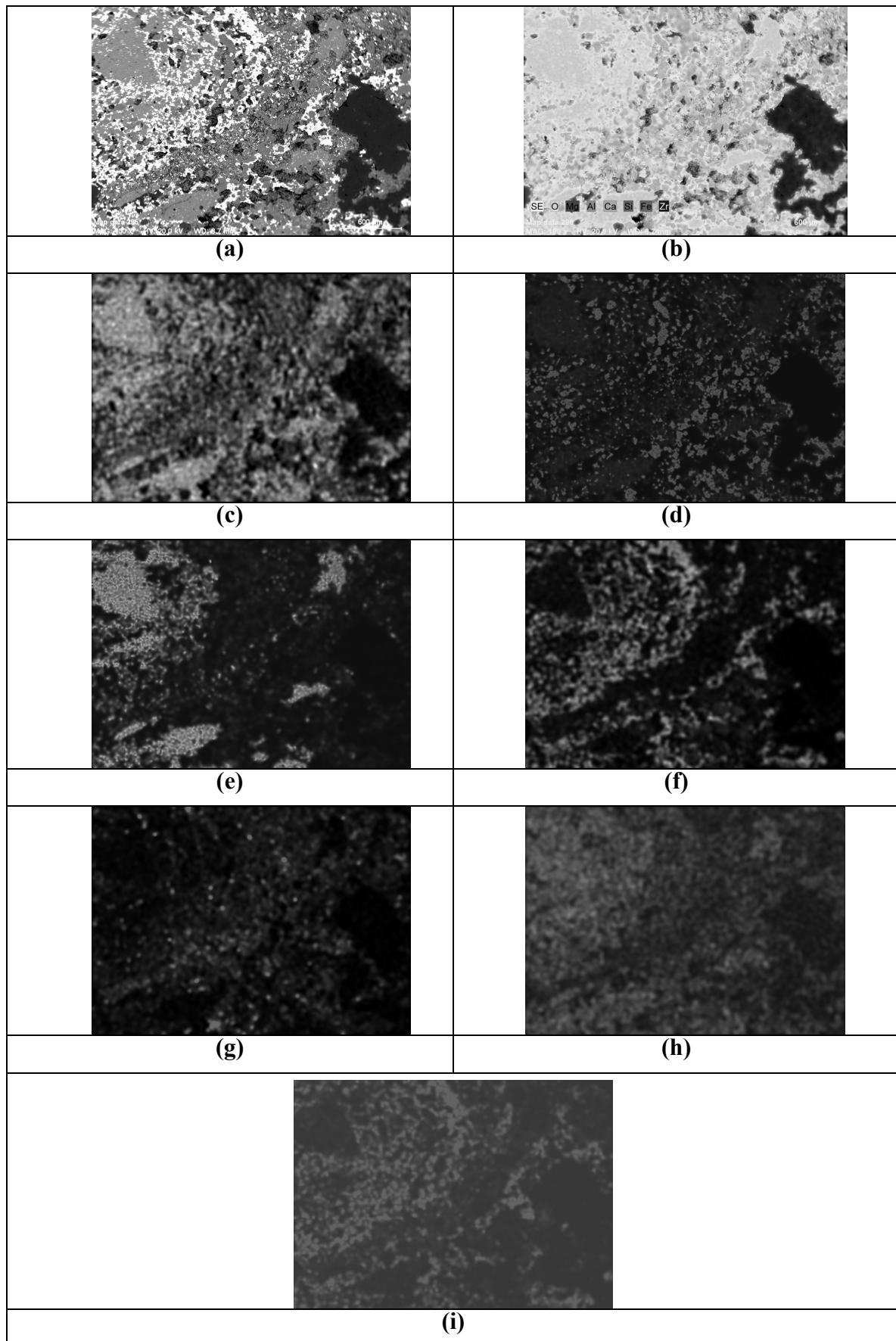
Şekil 7. Çimento klinkeri ile M-%30S-%30Zirkon kompozisyonundaki refrakterin ara yüzeyinde koroziona uğrayan bölgenin mikroyapısal görüntüsü [(a), (b)] ve elementlerin dağılımları [(c) O, (d) Mg, (e) Al, (f) Ca, (g) Si, (h) Fe, (i) Zr].
