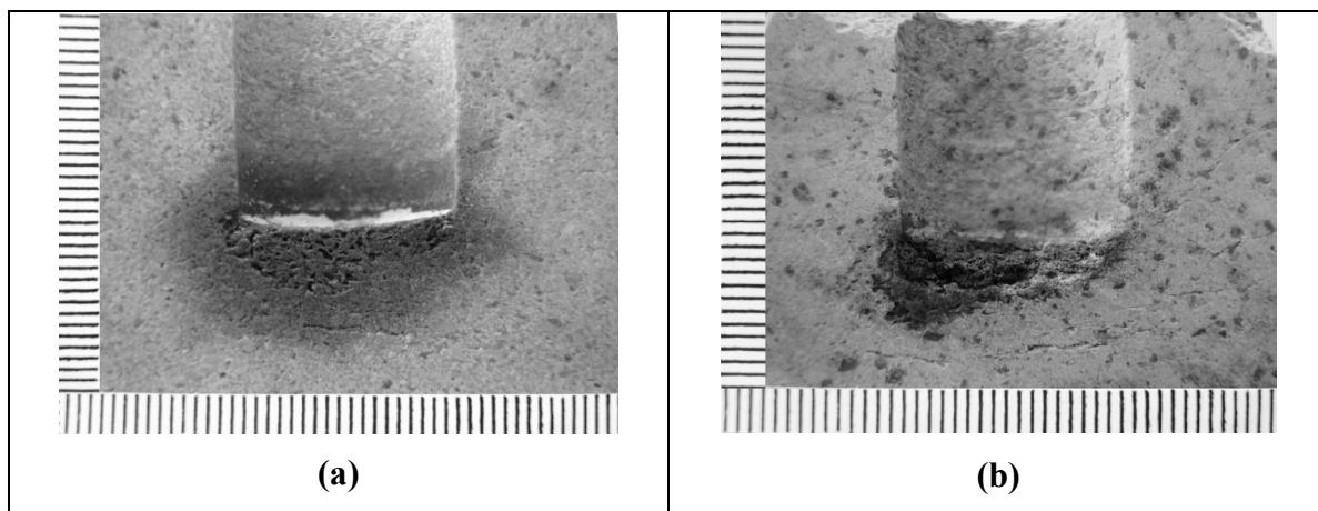
Şekil 1. Silindir şeklinde hazırlanarak korozyon testleri yapılan (a) M-%30Spinel ve (b) M-%30S-%30Zirkon içerikli refrakter malzemeler (Ölçek: 1 mm).
