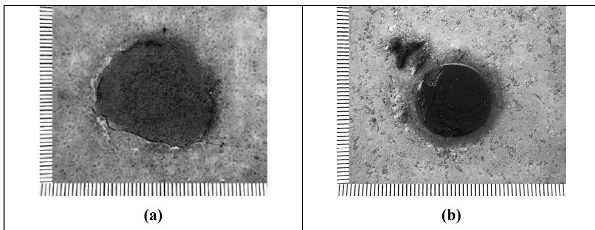
Şekil 8. Kare şeklinde hazırlanarak korozyon testleri yapılan (a) M-%30Spinel ve (b) M-%30S-%30Zirkon içerikli refrakter malzemeler (Ölçek: 1 mm).
