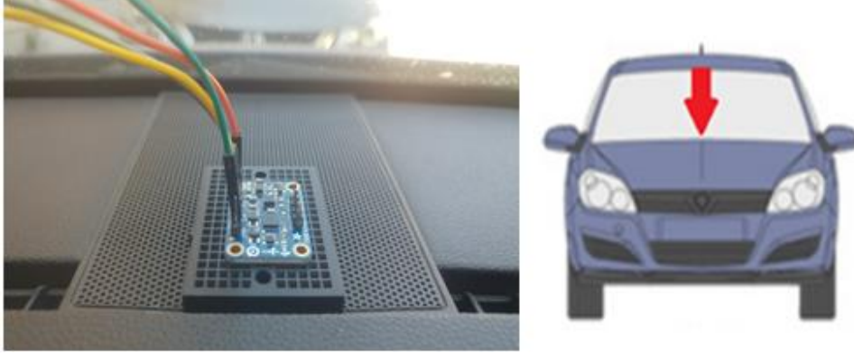
Şekil 7. Araç İçi Sensör Noktası Taslakla Beraber İç Görünüm
