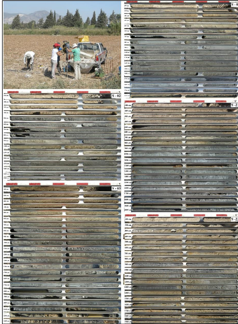
Şekil 4. Sondaj çalışmalarından bir görünüm (Sol üstte) ve yapılan sondajlara ait birleştirilmiş karot fotoğrafları
