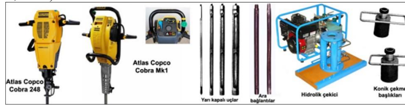
Şekil 3: Sondajlarda kullanılan temel ekipmanlar. Benzinli farklı özellikteki Atlas Copco Cobra 248 ve Mk1 modelleri, örnek alımını sağlayan farklı çaplardaki yarı kapalı uçlar, ara bağlantı boruları, hidrolik çekici ile konik çekme başlıkları.
