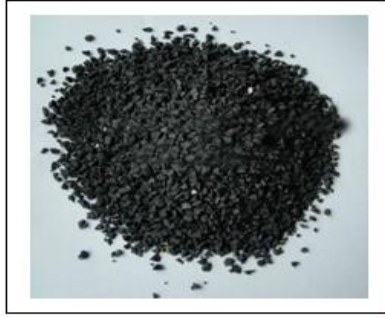
Şekil 2. Çalışmada kullanılan granül lastik Figure 2. Granulated rubber used in the study
