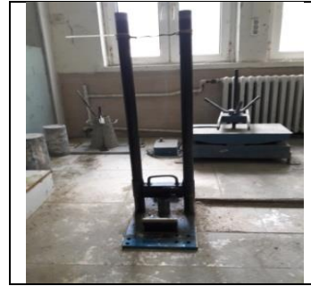
Şekil 5. Darbe deneyi aleti Figure 5. Impact test device
