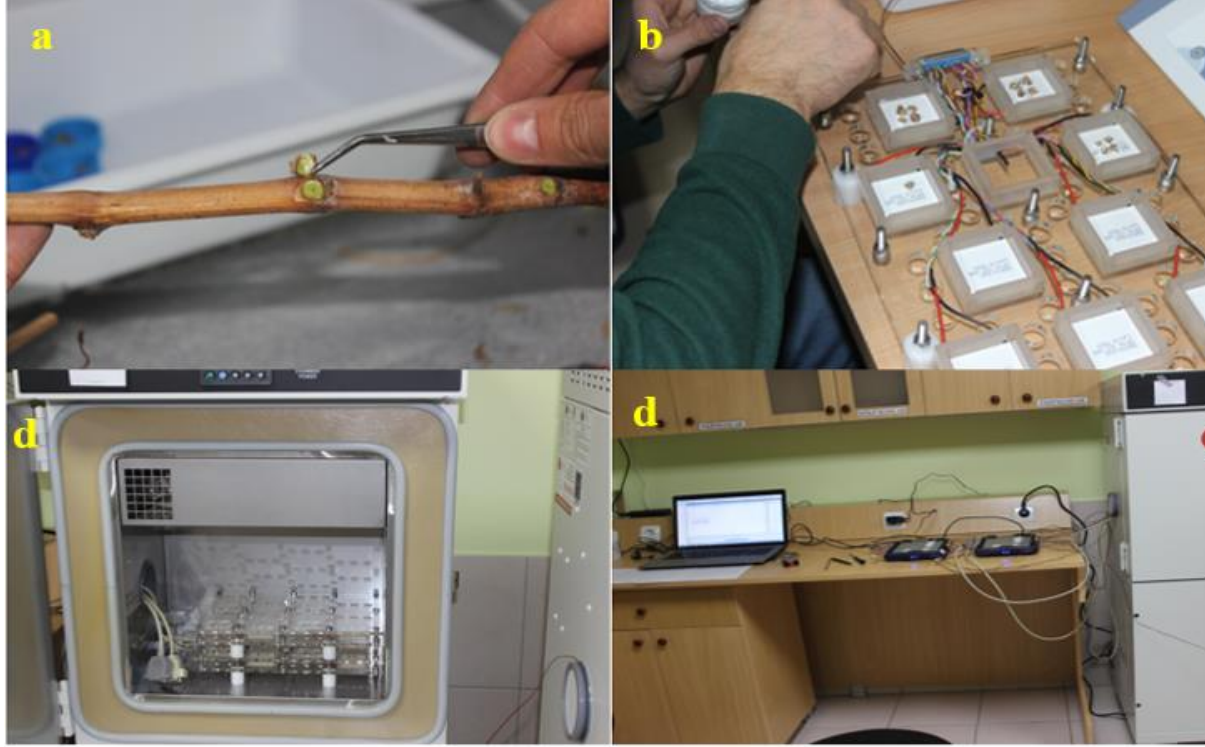
Şekil 1. DTA yönteminin ile kış gözlerinde mLTE değerlerinin belirlenmesi; a. tomurcuk yatağının altında 1-2mm odun dokusunun kesilmesi b. tomurcukların termoelektrik modüllere yerleştirilmesi, c. tomurcukların sıcaklık kontrollü kabine konulması, d. sıcaklık kontrollü kabine konulan tomurcuklarda veri kayıtlarının alınması
