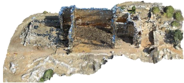
Şekil 15. Birleştirilmiş nokta bulutlarının Agisoft PhotoScan yazılımında görünümü
