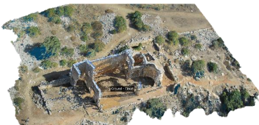
Şekil 14. Cloud compare yazılımında birleştirilmiş renkli (Kırmızı, Yeşil, Mavi) nokta bulutları
