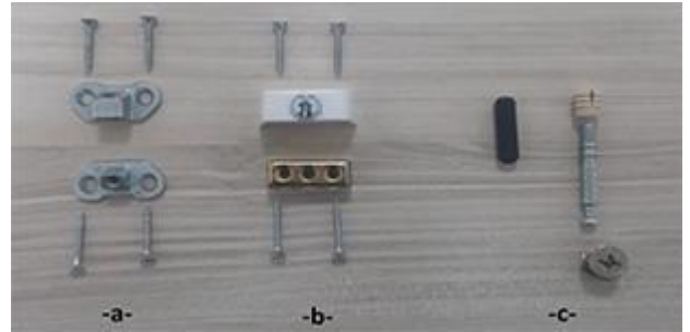
Şekil 1. Çalışmada kullanılan köşe birleştirme elemanları; (a) kelebek, (b) tırnaklı trapez (çektirmeli), (c) minifix (çektirmeli)
