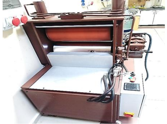
Şekil 2. Laboratuvar tipi iki silindirli yumuşak kalenderleme cihazında
