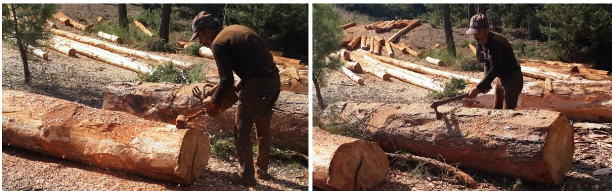
Şekil 4. Kabuk soyma aleti ile soyma (solda) ve balta ile çevirme (sağda) işleri
