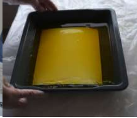
Şekil 2. Baskı İçin Materyal Hassaslaştırma
