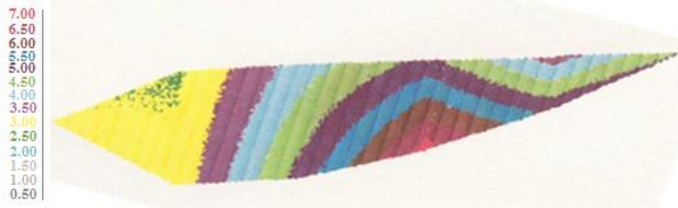
Şekil 12. Rüzgar türbin kanadının uç kapak elemanındaki gerilmeler (MPa)
