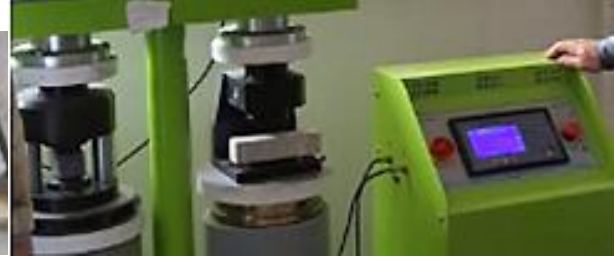
Şekil 1. Boraks Pentahidrat ikameli çimento harçları ve mekanik deneyler
