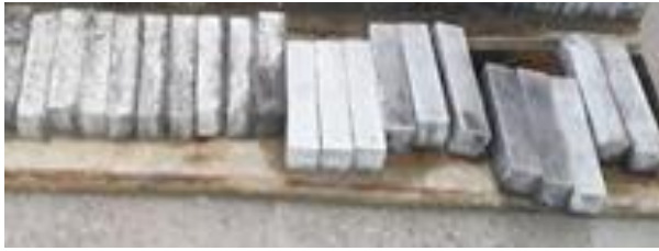
Şekil 1. Boraks Pentahidrat ikameli çimento harçları ve mekanik deneyler
