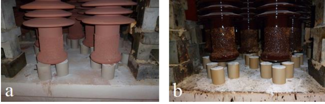
Şekil 4. a)Sinterlenme öncesi izolatörlerin dizilme şekli, b)Sinterlenme sonrası izolatörlerin kendini askıya almış hali
