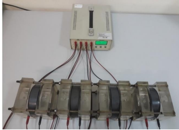
Şekil 2. Klor iyonu geçirirlik deney düzeneği
