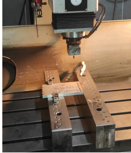
Şekil 5. Inconel 718 alaşımlı malzemenin dalma erozyon ile kare form işleme
