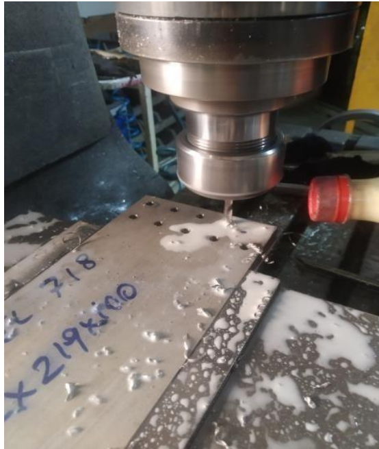
Şekil 3. Inconel 718 alaşımlı malzemeye ön delik delme işlemi
