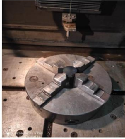
Şekil 6. Ti-6Al-4V malzemeye ön delik delme
