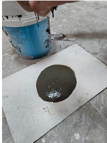
Şekil 2. Çökme deneyi (TS EN 1170-1' e göre)
