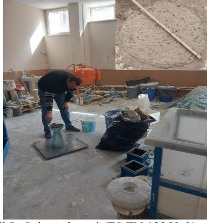
Şekil 3. Çökme deneyi (TS EN 12350-8' e göre)
