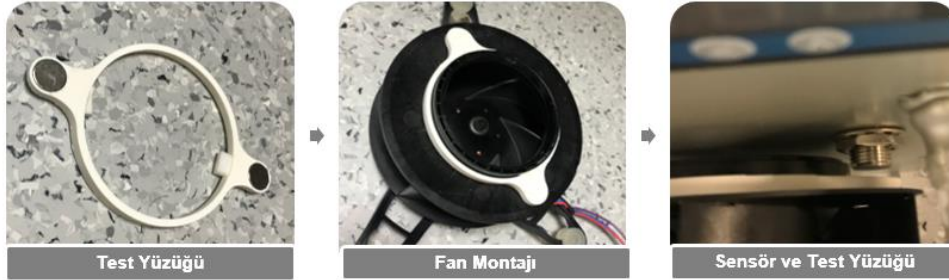
Şekil 3. Test yüzüğü fan montajı
