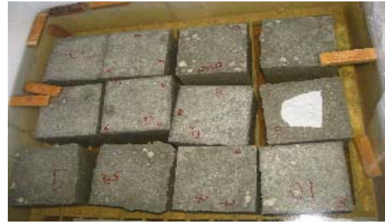
Fotoğraf 4. Numunelere Kür Uygulanması
