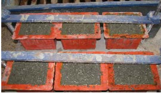
Fotoğraf 3. Numunelerin Kalıplara Dökümü
